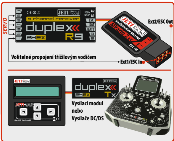
Obr. 2: Zapojení MVario2 do vstupu přijímače
