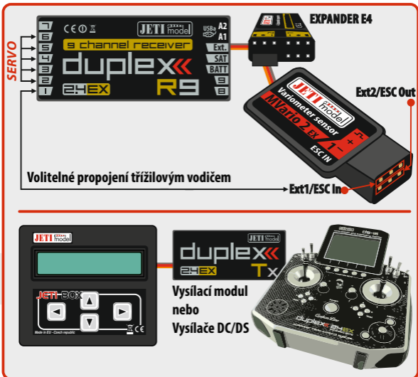
Obr. 3: Zapojení MVario2 prostřednictvím Expanderu
