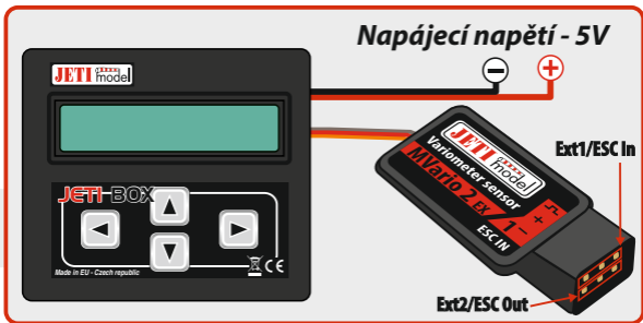
Obr. 1: Zapojení MVaria2 k Jetiboxu
